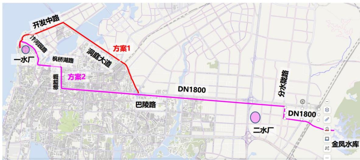
图 4.1.4-1 一水厂供水管道复线方案图
