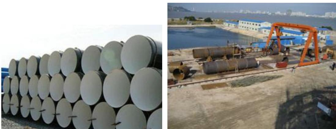
图 4.3.1-1 涂塑复合钢管制作实例
