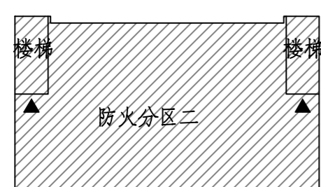
二层防火分区示意图 ▶表示疏散出口
