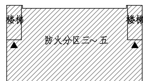
三~五层防火分区示意图 ▶表示疏散出口
