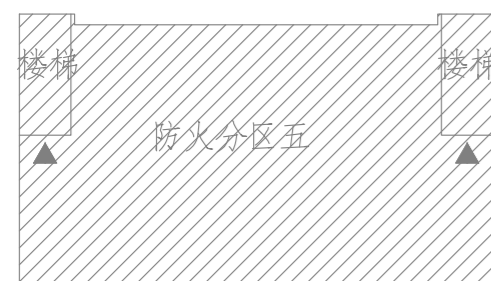
五层防火分区示意图 ▶表示疏散出口
