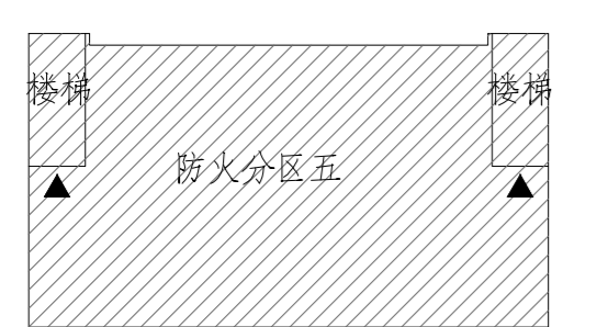
五层防火分区示意图 ▶表示疏散出口
