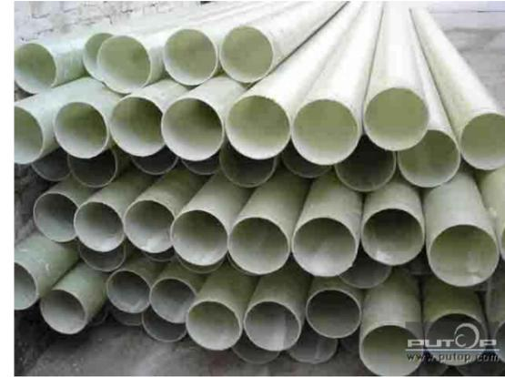
该管道具有耐腐、抗老化、使用寿命长、重量轻、抗渗漏、安装方便等优点。但玻璃钢夹砂管与同管径的其他管材相比，价格偏高，且抗击集中外力和不均匀外力的能力相对较弱。该管对施工工艺要求较高，管道的破损修补等比较繁琐，不利于后期维护管理。
