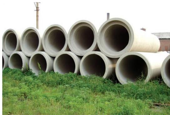
这种管材目前市政工程中用得最多，具有较成熟的制作工艺和施工经验，可以根据不同的埋深、内压进行配制，管道系列齐全，接口型式由于采用橡胶止水带，止水效果较好（F 管尤佳），价格较低，施工方便，管道埋于地下变形较小，适用于开槽埋管和顶管施工。但其重量大，起吊设备要求较高，大口径管道运输困难，施工周期较长。
